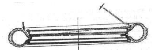
Рис. 69. Правильное положение покрышки на обode колеса при ее демонтаже (пунктиром показано кратчайшее расстояние между бортами крышки)
