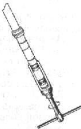
Рис. 98. Снятие направляющих втулок неподвижной трубы пера передней вилки при помощи съемника.
