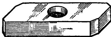
31. Подкладка для выпрессовки пальца из щеки коленчатого вала
